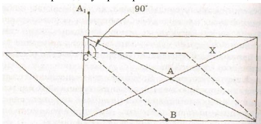
планки, высота которой не должна быть меньше расстояния АВ. С помощью угольника ставим планку вертикально на точку С, откладываем на ней расстояние, равное АВ. Точка напротив центра экрана А<sub>1</sub>- лампа.
